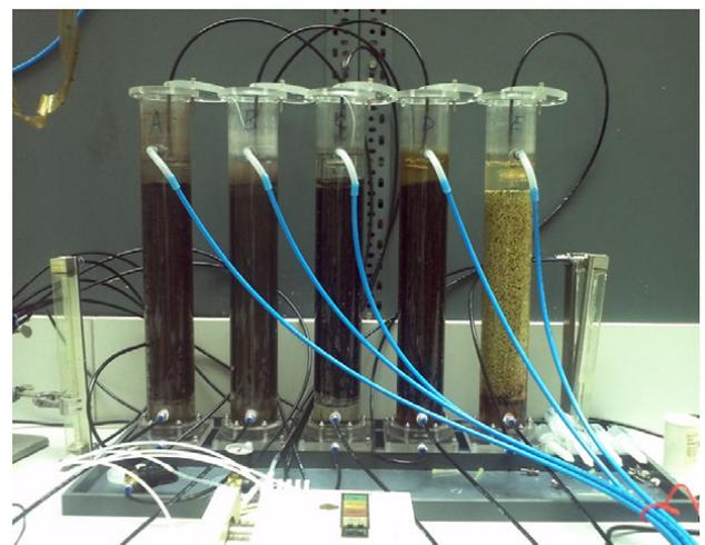
Versuchsanlage zur Entfernung von Spurenstoffen mit Reaktoren zur Anreicherung von Eisenbakterien
