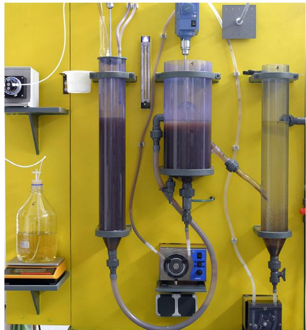
Über eine Kläranlage im Laborformat wird erforscht, wie Schadstoffe abgebaut werden
