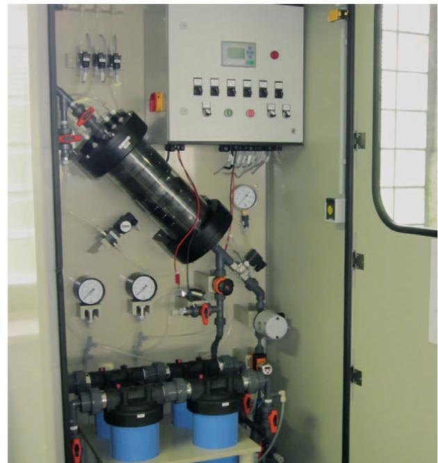
Versuchsanlage zum Test innovativer Oxidationsverfahren zur Entfernung von Mikroverunreinigungen
