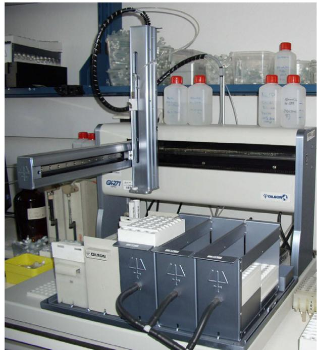
Automatisches System zur Vorbereitung der Abwasser- und Klärschlammproben.
