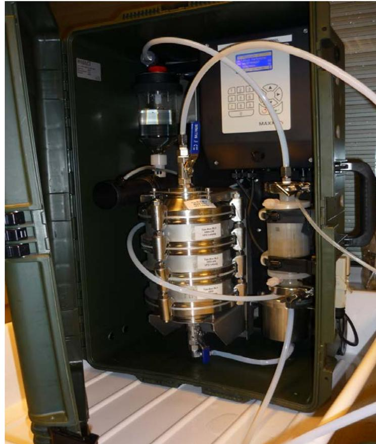
Mobiler Prototyp für die vollautomatische Festphasenextraktion von bis zu 1000 Litern Wasserprobe
